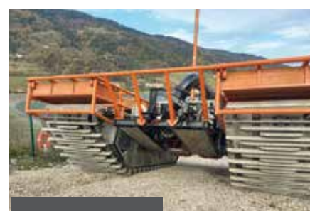
Les chenilles du robot @SUPER NESSIE qui lui permettent d'avancer sur les sédiments au fond de la retenue
